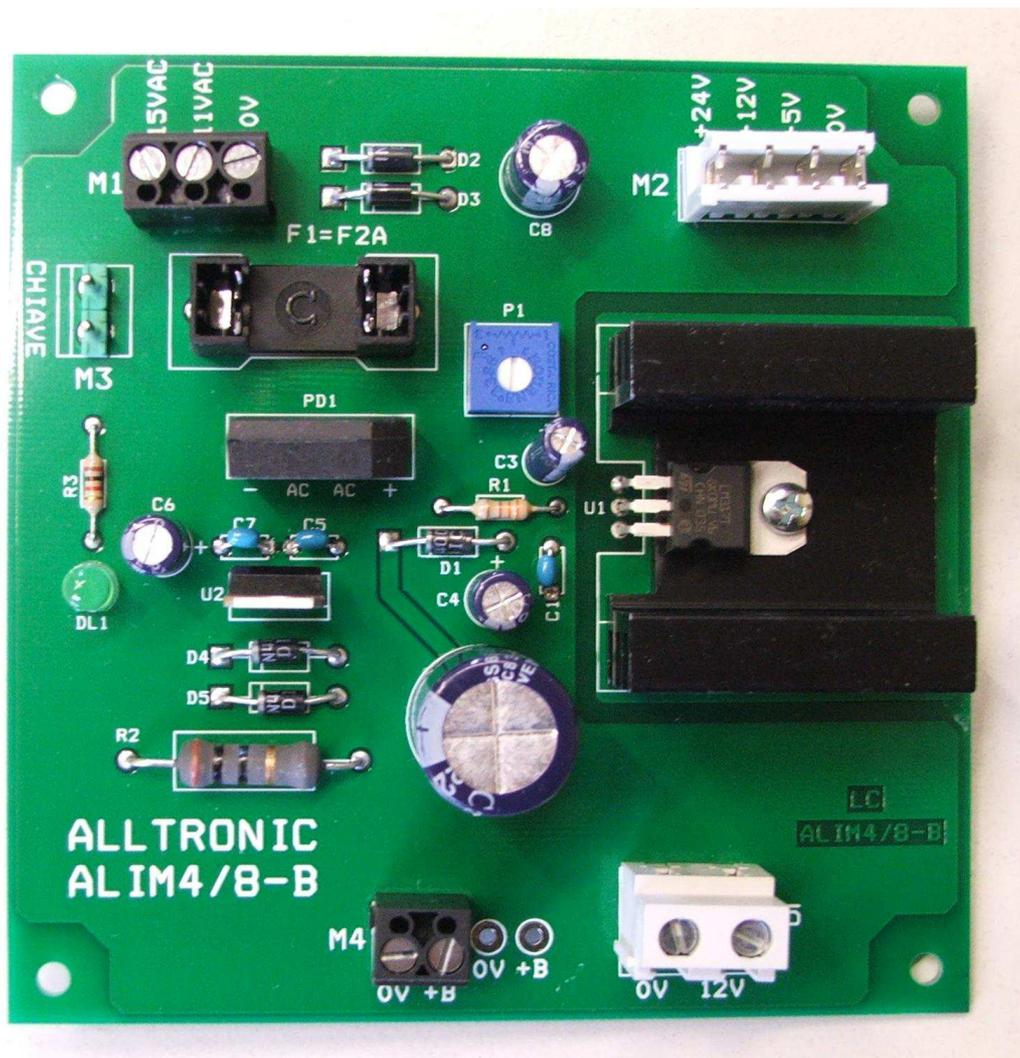
**ATTENZIONE** : prima di collegare il 230V, controllare il corretto collegamento dei fili 0V e +12V (ai sensori) perché, se invertiti, bruciano tutti gli integrati della centrale.
